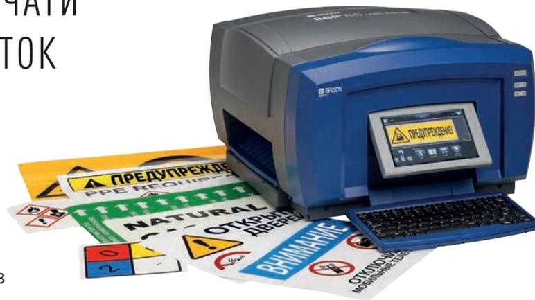
Принтер для печати знаков и этикеток VBR™85 — это настольный термотрансферный принтер с разрешением 300 точек на дюйм, предназначенный для печати на ярких многоцветных материалах шириной до 254 мм.
