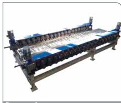
Вальцовочный станок для системы изготовления воздуховодов с интегрированными фланцами
