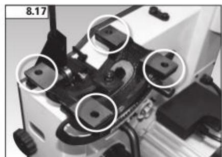
Цапфа стола имеет 4 отверстия, как показано на рис. 8.17, нижняя сторона стола имеет 4 соответствующих резьбовых отверстия, как показано на рис. 8.18. Поместите стол на цапфу, как показано на рис. 8.19, не повредив его, осторожно пропустите лезвие через щель стола.
