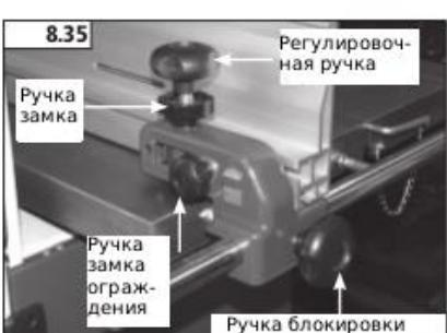
Закрепите ограждение с помощью ручки блокировки ограждения, как показано на рис. 8.35. Ограждение и крепление крепятся на рельсе с помощью ручки фиксации положения, как показано на рис. 8.35.
