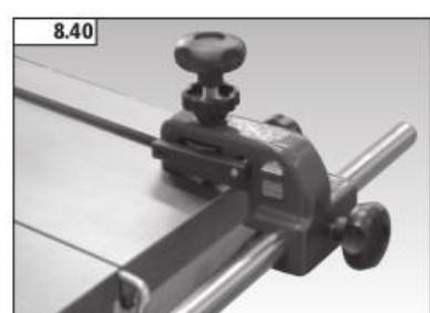
Ограждение также может быть установлено, как показано на рис. 8.36. Эта позиция позволяет направляющим двигаться дальше вниз для поддержки лезвия для резки тонких материалов.
