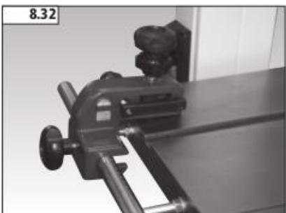
Чтобы упор лежал параллельно столу, установите на поверхности стола стальную линейку, как показано на рис. 8.30 и измерьте расстояние между линейкой и упором.
