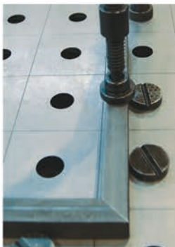
Адаптер 111, расширение позиционирования по высоте на 111 мм
