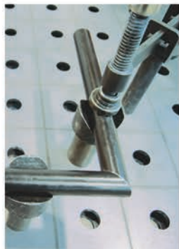
Адаптер 78, расширение позиционирования по высоте на 78 мм
