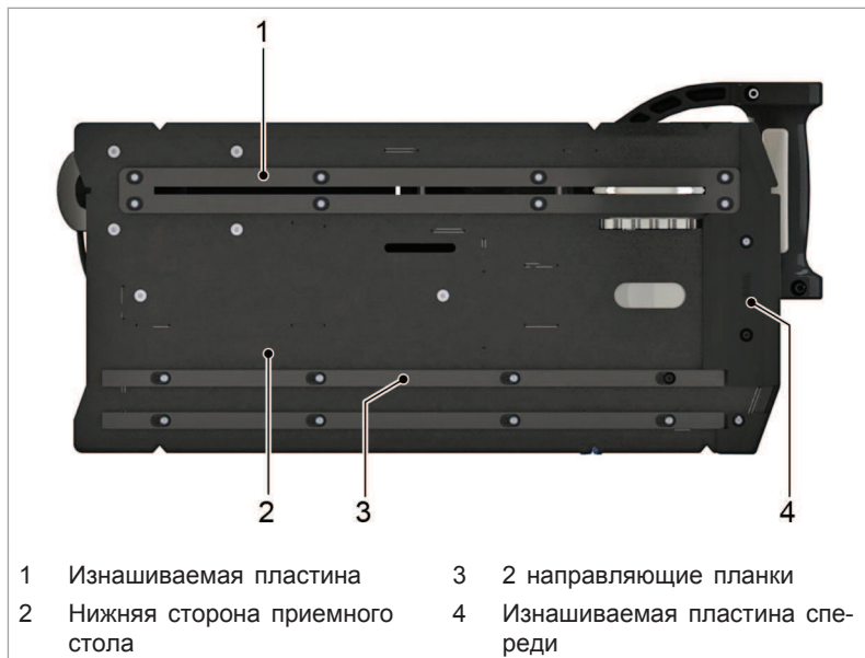
Нижняя часть стола инструмента с изнашиваемой пластиной и направляющими планками
