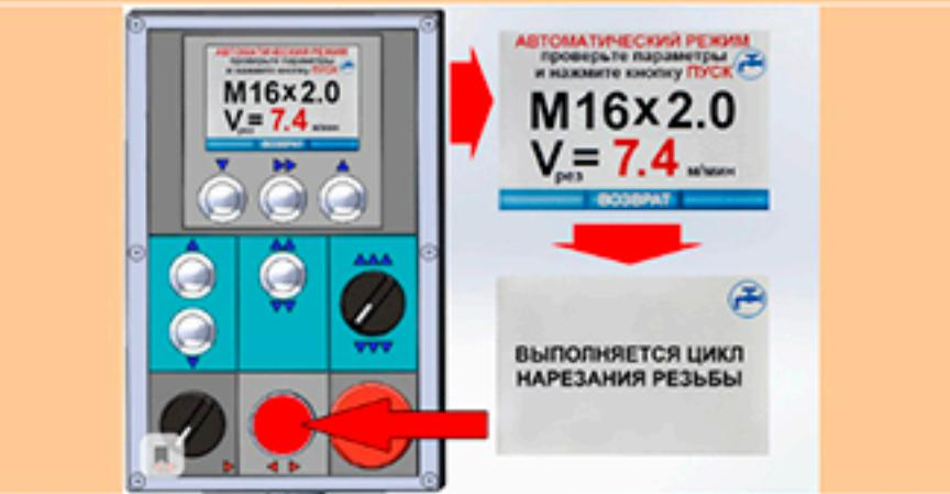
ВЫПОЛНЯЕТСЯ ЦИКЛ НАРЕЗАНИЯ РЕЗЬБЫ. ЦИКЛ, ЭТО МОМЕНТ ПОСЛЕ НАЖАТИЯ КНОПКИ ПУСК ДО ПОЛНОГО ВОЗВРАТА КАРЕТКИ В ИСХОДНОЕ ПОЛОЖЕНИЕ
